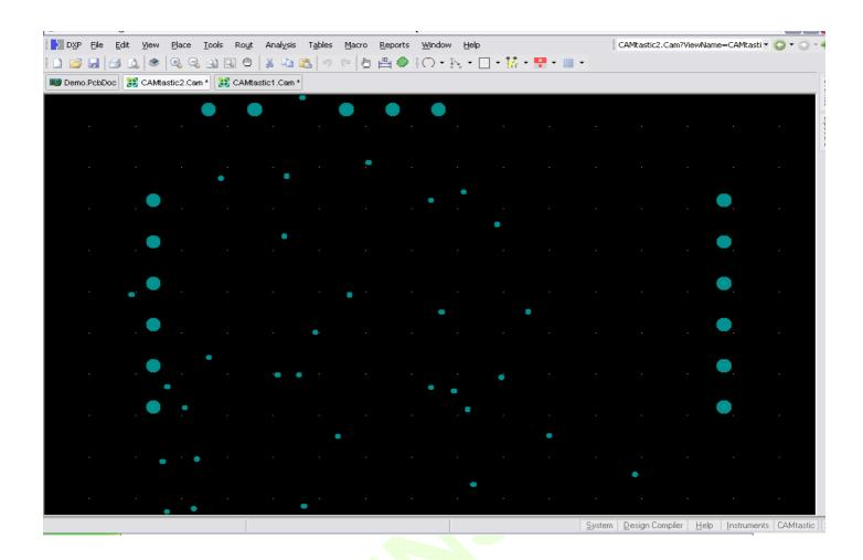
En la figura se puede observar la representación grafica del archivo de perforaciones en función de su diámetro. El usuario evaluara esta característica para determinar si corresponde a lo diseñado.
